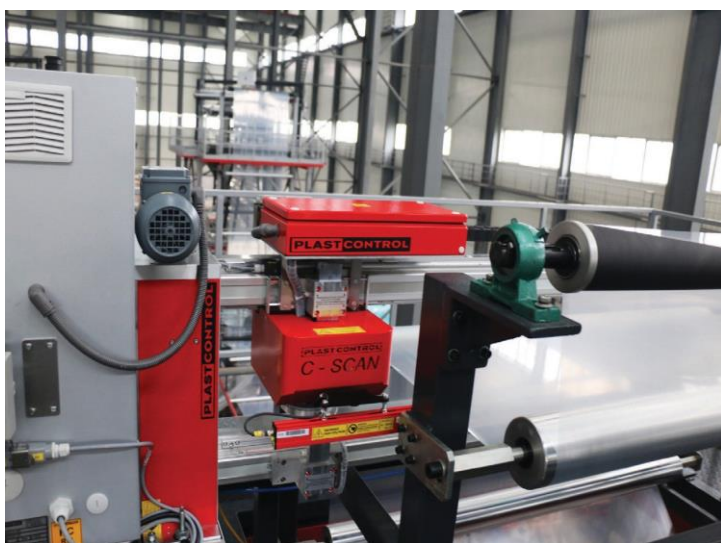
Hochpräzises Messsystem der Foliendicke
